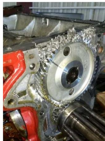
**Cam Gear Shredded**
