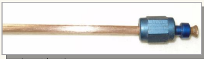
New Copper Primer Line.
