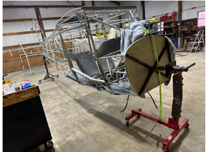
Fuselage on Rotisserie.JPG
